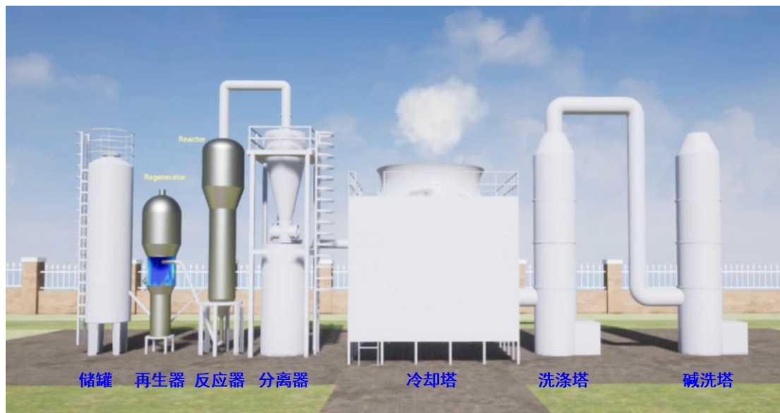
图 1 甲醇制烯烃（MTO）示范装置虚拟过程工程示意图
